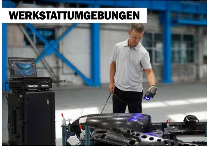
Mit dem mobilen Werkstattwagen von Creaform können die Mitglieder des Qualitätssicherungsteams unabhängig von ihrer Qualifikation die Teile während aller Phasen des Fertigungsprozesses direkt im Fertigungsbereich prüfen. Hauptsächlich ausgelegt zur Einrichtung eines tragbaren 3D-Scanners im gesamten Fertigungsbereich ist dieser Werkstattwagen ein leistungsstarkes Hilfsmittel, um die Effizienz und Leistung Ihrer Qualitätssicherung zu steigern.
